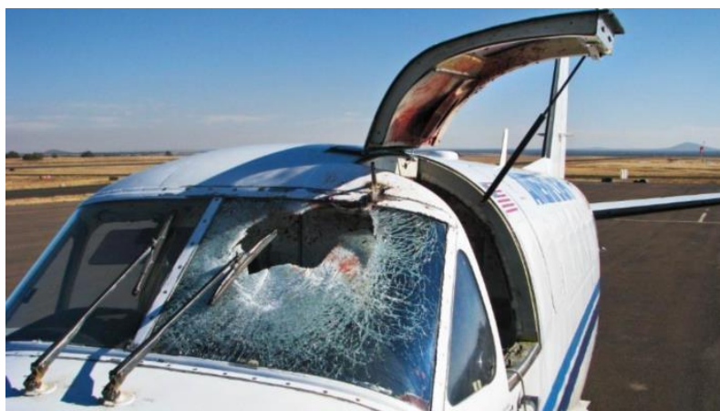
Figura 2 – Dano pelo impacto de ave em para-brisa de aeronave
