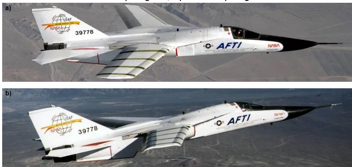
Figura 8 – Aeronave F-111 em voo com curvatura morphing : a) antes do morphing e b) após o morphing
