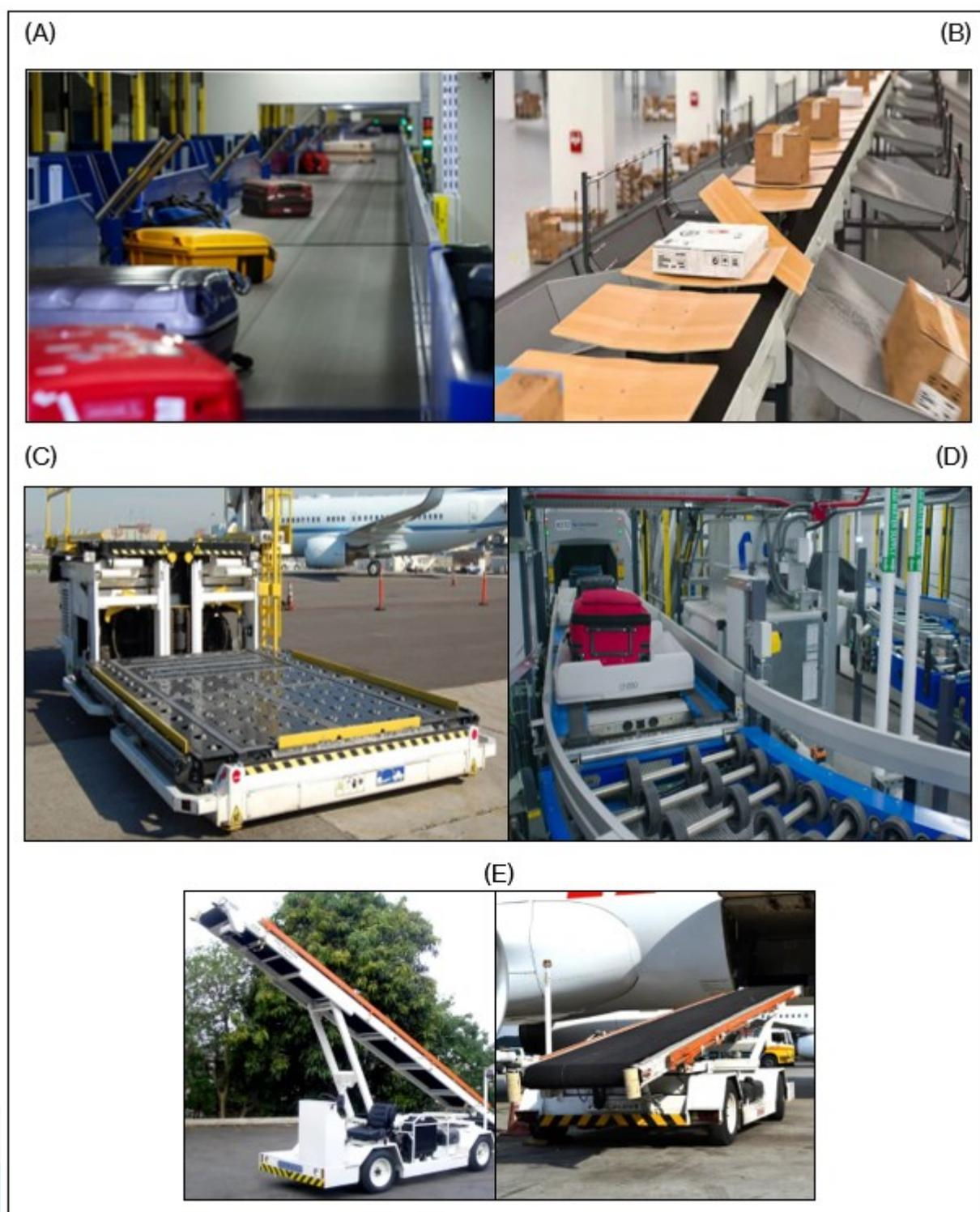
Legenda: **(A)** Tecnologia de esteiras; **(B)** Tecnologia Tilt-tray loop; **(C)** Loader; **(D)** Individual carrier system; **(E)** Conveyor.
