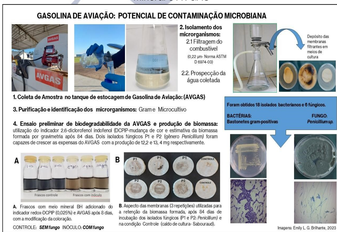
Figura 5 - Etapas de avaliação da prospecção microbiana de amostras de gasolina de aviação (AVGAS), com o isolamento, caracterização dos microrganismos e capacidade preliminar do crescimento de fungos do gênero Penicillium sp. em microcosmos com meio mineral e AVGAS
