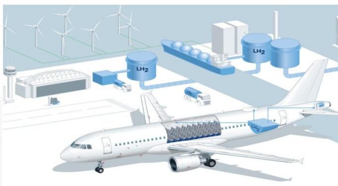
Figura 7 – Concepção tanque de combustível pela Lufthansa
