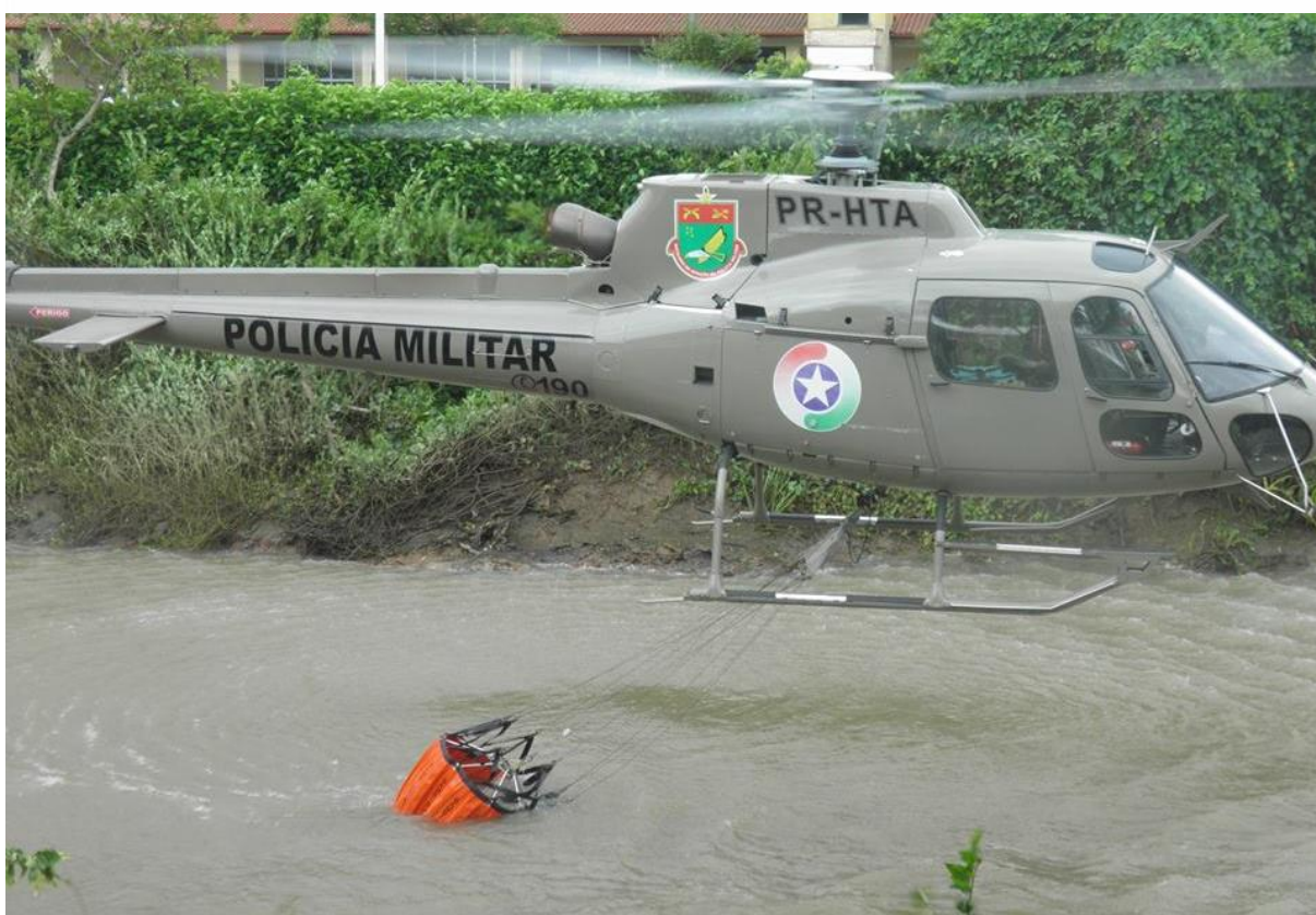
Figura 7 - Helicóptero equipado com helibalde realizando reabastecimento em um rio
