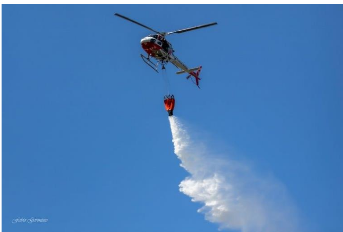
Figura 6 - Helicóptero acionando seu helibalde.
