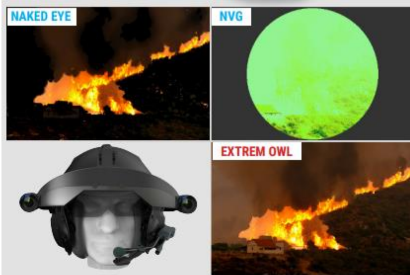
Figura 28 - Figura realizando a comparação entre visão a olho nu (naked eye), óculos de visão noturna (NVG) e Extrem Owl.
