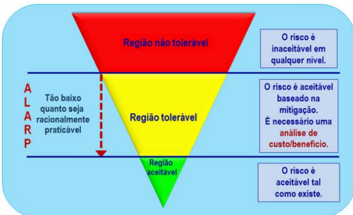
Figura 21 - Sistema ALARP para mitigação de riscos.
