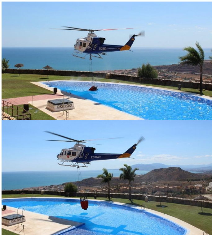
Figura 10 - Helicóptero Bell 412 reabastecendo helibalde em piscina.
