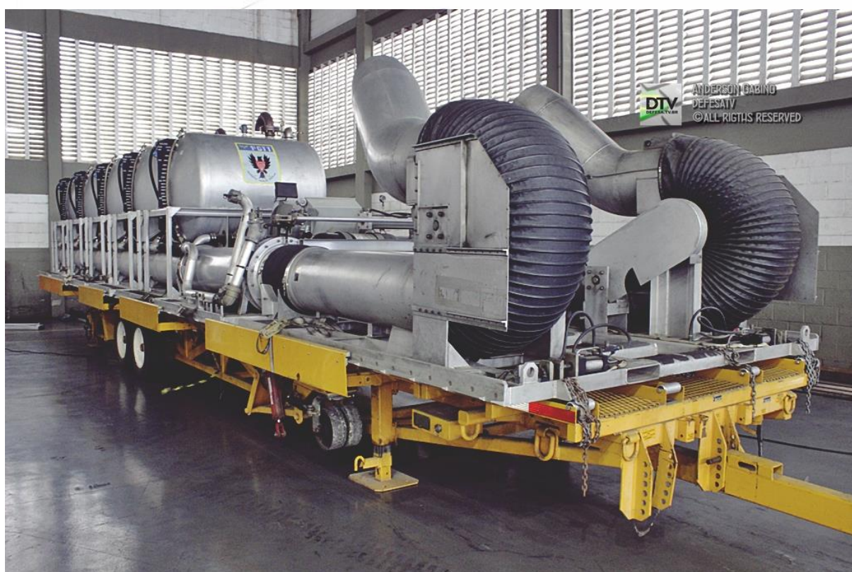
Figura 4 - Sistema MAFFS utilizado pela Força Aérea Brasileira.
