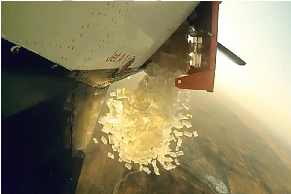
Figura 26 - Pellets líquidos sendo lançados pelo sistema Hydrop.
