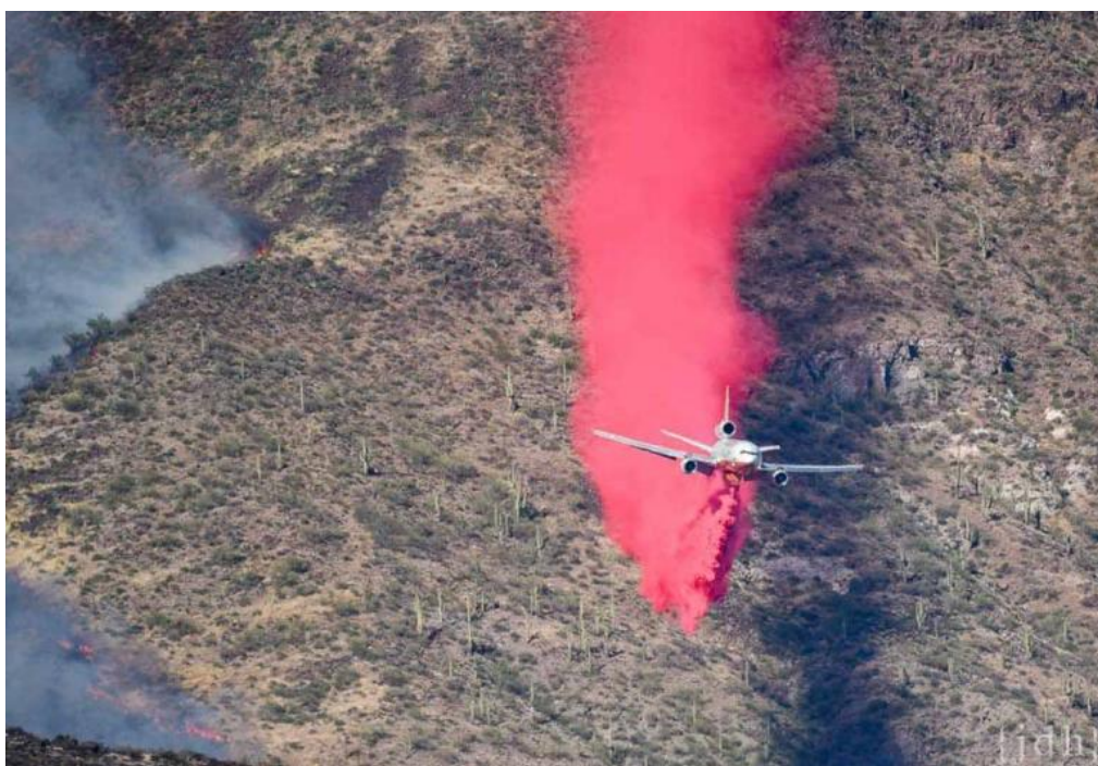
Figura 12 - Aeronave criando barreira química por meio do método indireto de lançamento de retardante de chamas.
