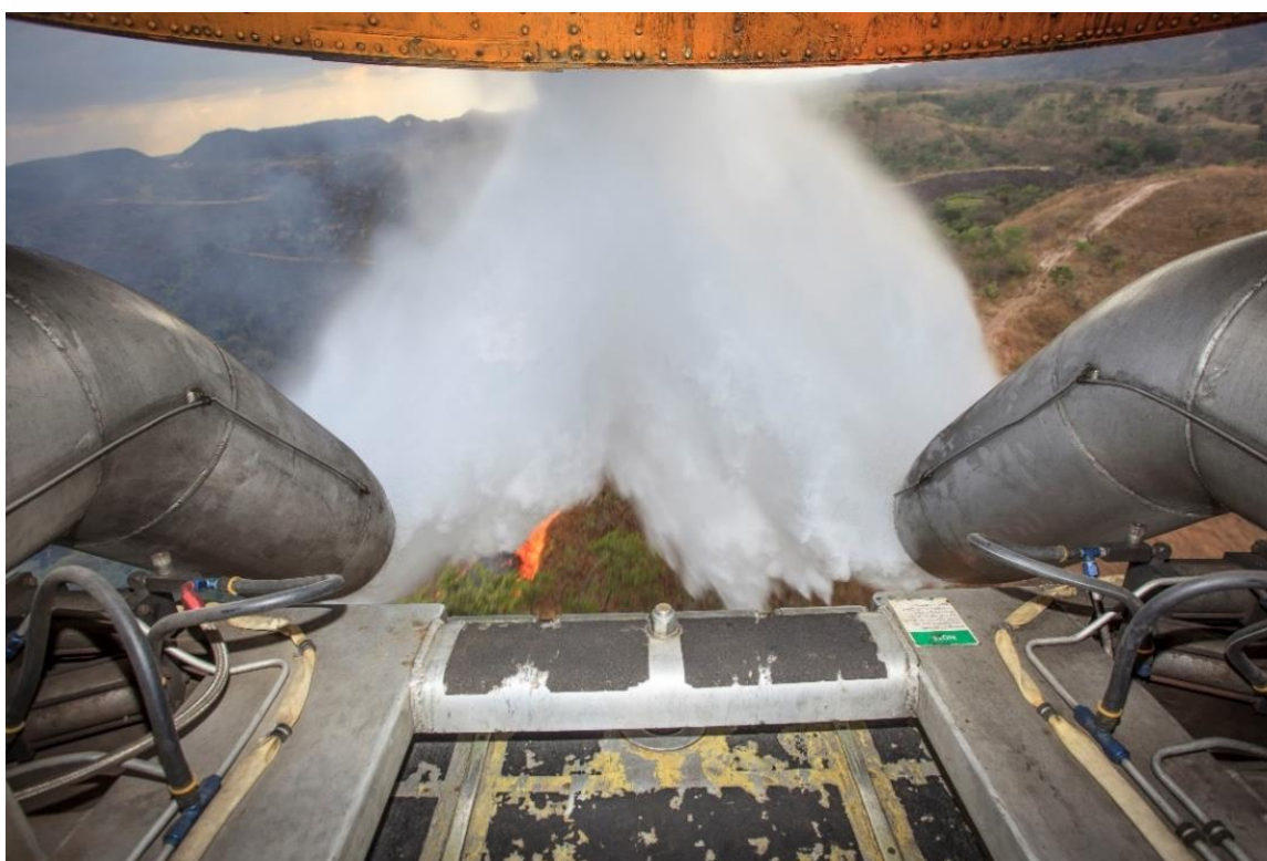
Figura 3 - Sistema Maffs sendo utilizado em combate a incêndio florestal.
